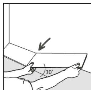
Halten Sie bereits bei der ersten Elementreihe und anschließend zu allen weiteren aufsteigenden Bauelementen (Wände, Säulen, Heizungsrohre etc.) mindestens 10 mm Abstand. Dies kann durch Abstandskeile bewerkstelligt werden. Nichtbeachtung führt zu einem eingespannten Zustand der schwimmenden Konstruktion und führt zu Aufwölbungen im Bodenbelag und in der Folge ggf. zur Zerstörung des Bodenbelags.
