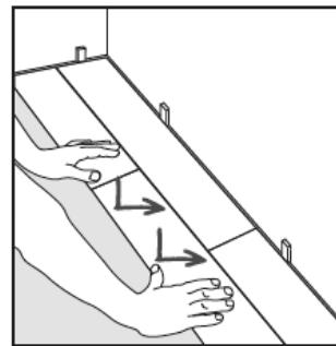
Zusätzlich haben Sie die Möglichkeit, nach dem längsseitigen Einwinkeln die stirnseitige Verbindung durch leichtes horizontales Einklopfen mittels passenden Schlagklotz zu verriegeln. Klopfen Sie von der freien Stirnseite in Richtung des bereits liegenden Elements. Achten Sie hierbei darauf, dass die Höhenlage der Elemente zueinander passt.
