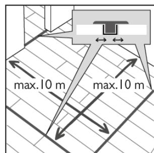
Eine Fixierung der schwimmenden Konstruktion durch schwere Gegenstände, wie Küchenzeilen, Öfen, Aquarien, Wasserbetten etc. muss vermieden werden. Ist dies unvermeidbar, muss der Bodenbelag sich von der Fixierung ausgehend frei in alle verbleibenden Richtungen ausdehnen können. Bei Nichtbeachtung kann es u.a. zu Fugenöffnungen kommen, sicher aber zu einem unbefriedigenden Gesamteindruck.
