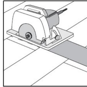
Zur Vorbereitung des Ersatzelements schneiden Sie sowohl an der Stirn-, als auch an der Längsseite vorsichtig die Feder ab, sodass die Verriegelungsnut nicht beschädigt wird.
