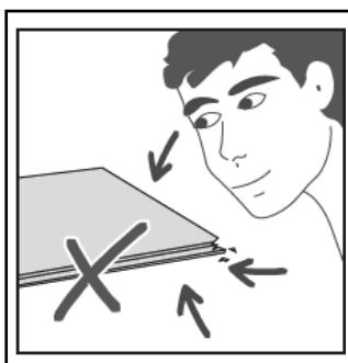
Während der Verlegung die Elemente aus mindestens drei oder mehr Paketen mischen und auf Materialfehler überprüfen. Elemente mit sichtbaren Materialfehlern dürfen nicht verlegt werden.
