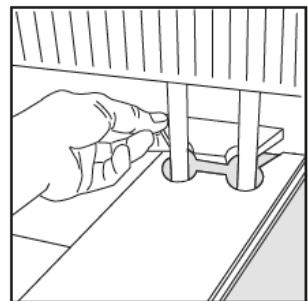
Türen: Markieren Sie mittels Elementabschnitt oder anhand eines gedrehten Elements die Schnittmarke an der Türzarge. Passen Sie die Türzarge mit geeignetem Werkzeug entsprechend an.
