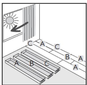
Schneiden Sie die Elemente der letzten Reihe auf Maß. Wenn das Element nicht von oben eingewinkelt werden kann, schneiden Sie die Nase der unteren Nutwange ab, und tragen Sie etwas wasserfesten D3-Weißeim auf. Anschließend setzen Sie die Diele einfach ein. Berücksichtigen Sie hierbei auch den einzuhaltenden Randabstand.
