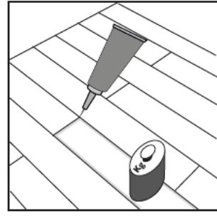
Nun tragen Sie den D3 Weißleim auf die Längs-, und Stirnseite des präparierten Elements sowie auf dem verbleibenden Clickmechanismus der angrenzenden Elemente auf. Anschließend führen Sie das präparierte Element von der Nut- zur Federseite hin ein und beschweren es, bis der Leim abgebunden hat.
